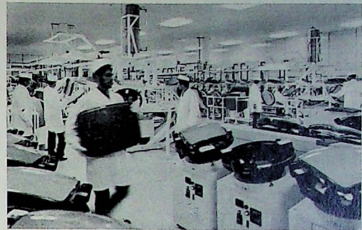
Bild 5. Lichthäuser zur Belichtung der Leuchtstoffpunkte
