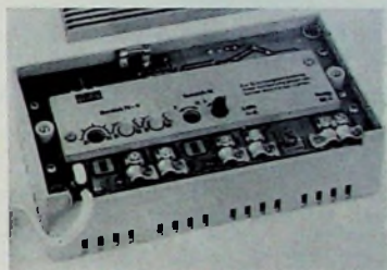
Bild 4. Breitbandverstärker „Euro Selector 4-4“ (Fuba)
